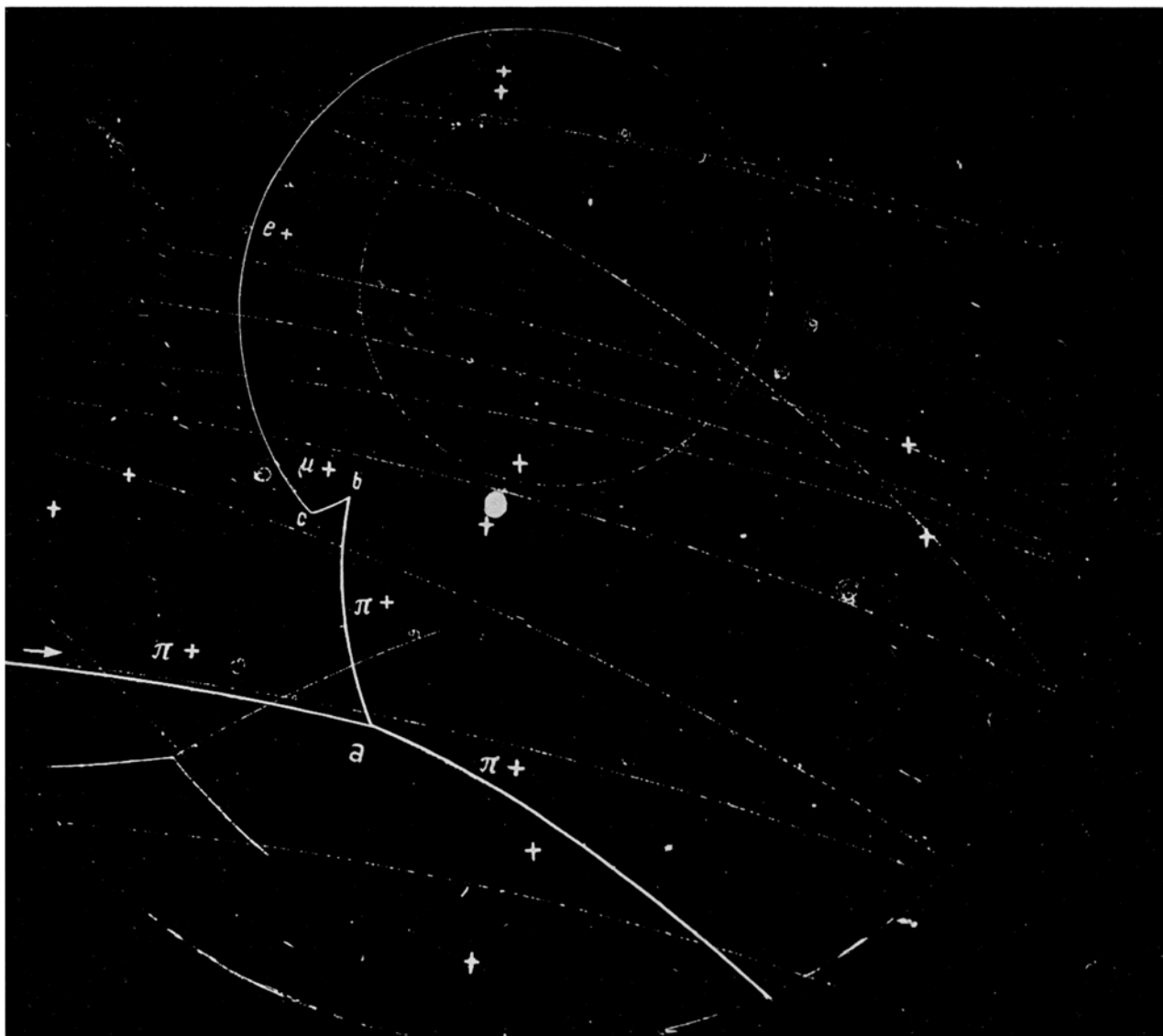
Abb. 3: Beispiel einer Wasserstoff-Blasenkammer-Aufnahme: Spuren von 330 MeV-Pionen
